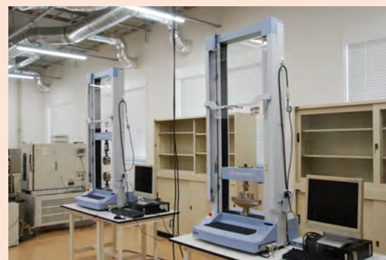
万能試験機 (小) 2台 荷重容量10kN
