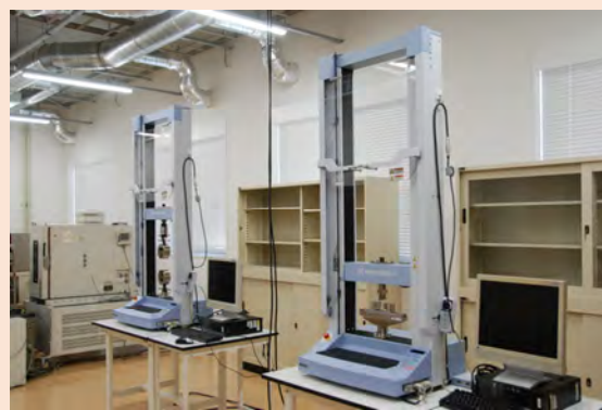
万能試験機 (小) 2台 荷重容量10kN
