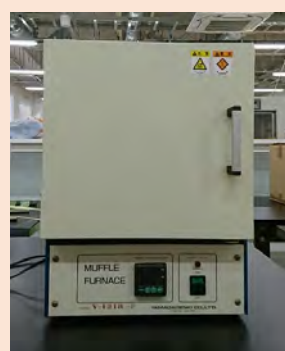
電気炉 最大加熱温度：1100°C
