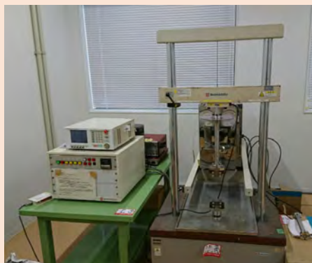
疲労試験機 1台 荷重容量10kN 恒温槽 (-35℃~250℃)
