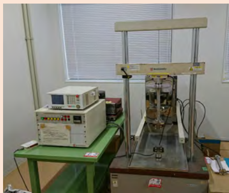
疲労試験機 1台 荷重容量10kN 恒温槽 (-35℃~250℃)
