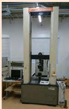
万能試験機 (大) 1台 荷重容量50kN 恒温槽 (-60℃~250℃)
