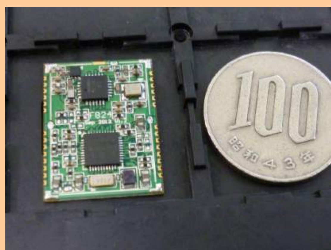
切手サイズのGPS受信機が、宇宙でも人工衛星をナビゲーションします。
